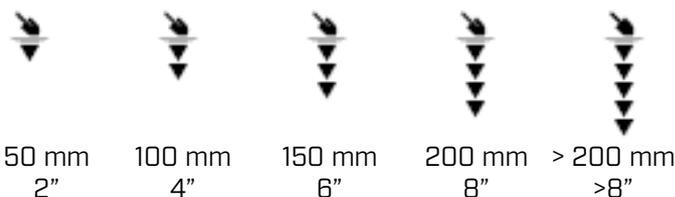
**i** La precisione dell'indicatore di profondità si riduce in terreni altamente mineralizzati.
