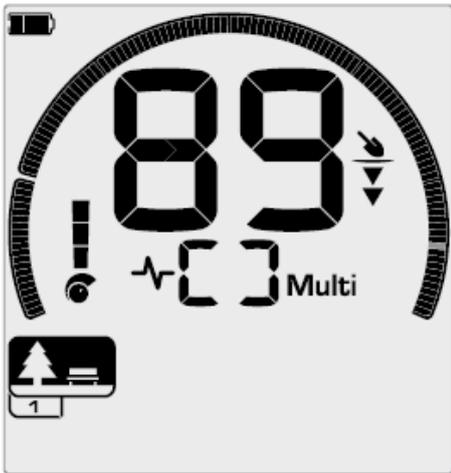
Quando viene rilevato un bersaglio, viene visualizzato un numero ID Target. Questo esempio mostra la rilevazione di una moneta da un quarto di dollaro poco profonda. Alla rilevazione, il segmento Target ID corrispondente lampeggia (segmento lampeggiante mostrato in grigio).
