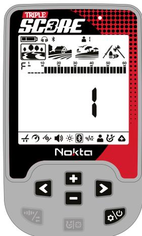
Quando la connessione wireless è attivata, l'icona delle cuffie Bluetooth® inizierà a lampeggiare nella sezione delle informazioni nella parte superiore dello schermo.
