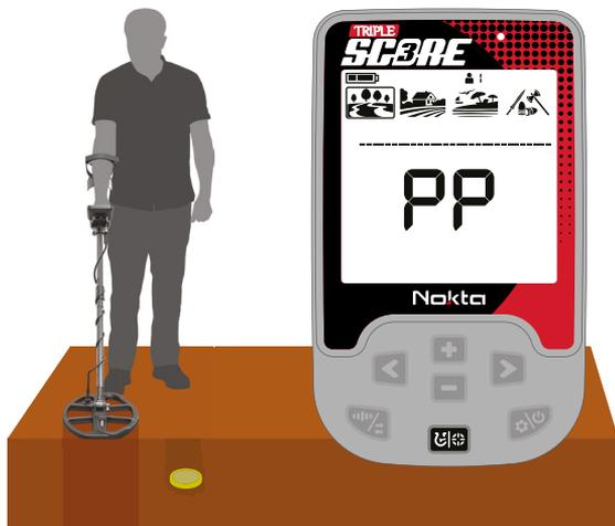
2. Tenere premuto il pulsante e avvicinare la piastra di ricerca al target lentamente e parallelamente al suolo.
