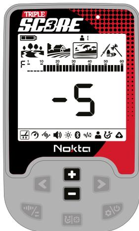
Il livello zero (0) del bilanciamento del terreno rappresenta il livello più stabile. Diminuire il livello di Stabilità verso -5 può aumentare i rumori provenienti dalla sabbia della spiaggia e aumentare la probabilità di rilevare metalli conduttivi deboli come l'oro, che danno un ID di 11.
