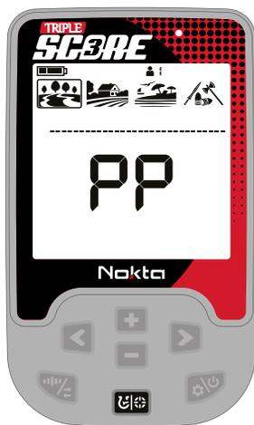
In modalità pinpoint, il dispositivo non discrimina i metalli né fornisce ID dei target.
