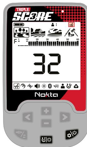
Il dispositivo aggiorna automaticamente il bilanciamento del terreno finché la piastra di ricerca viene fatta muovere sul terreno. Non fornisce alcun feedback all'utente.
