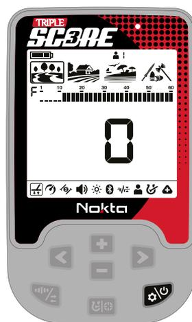
3. È necessario ascoltare i suoni provenienti dal terreno per eseguire il bilanciamento manuale del terreno. Pompate la piastra di ricerca su e giù da circa 15-20 cm (~6"- 8") dal suolo fino a 3 cm (~1") da terra con movimenti fluidi e mantenendola parallela al suolo.
