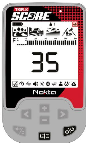
6. Se non si riesce a bilanciare il terreno, significa che il terreno è troppo conduttivo o non mineralizzato o che c'è un target proprio sotto la piastra di ricerca. In tal caso, riprovare a bilanciare il terreno in un punto diverso.
