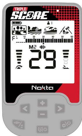
L'ID del target viene visualizzato con due cifre sul display e varia tra 01 e 60.
