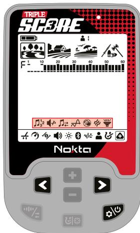
Nel modello TRIPLE SCORE, quando viene selezionata la modalità Relic, il menu delle Sotto-Impostazioni include solo le impostazioni per la Vibrazione e la Torcia LED, come mostrato di seguito.
